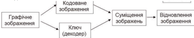
Рис. 2. Принципова схема кодування зображень.
