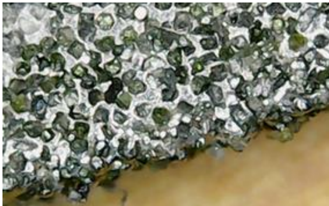
Рисунок 1 – Кластеризована поверхня пилки реноватора
