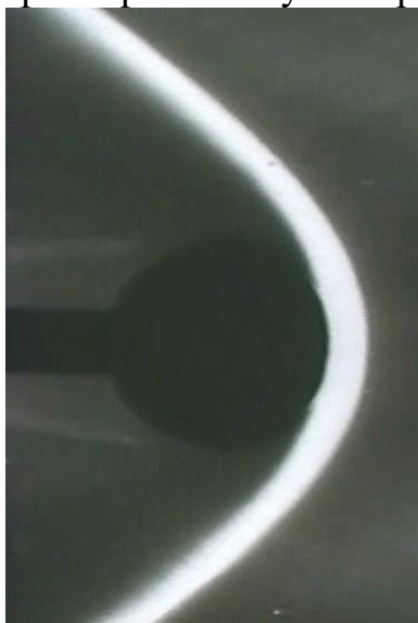
Рисунок 2 – Схема криволінійного стрибка ущільнення перед циліндричним тілом
