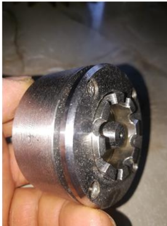
Рисунок 2 – Струминна головка для генерації криги безкамерним способом
