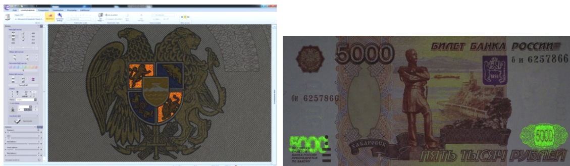
Рис. 6. Исследования ИК анти-Стоксовой люминесценции отдельных средств защиты
