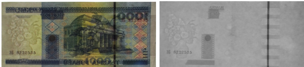
Рис. 4. Исследования в проходящем свете (белый и ИК 870 нм) в «Регула 4307»
