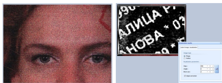
Рис. 10. RFS-визуализация скрытых изображений на примере интегрированного фотоизображения в паспорте Болгарии
