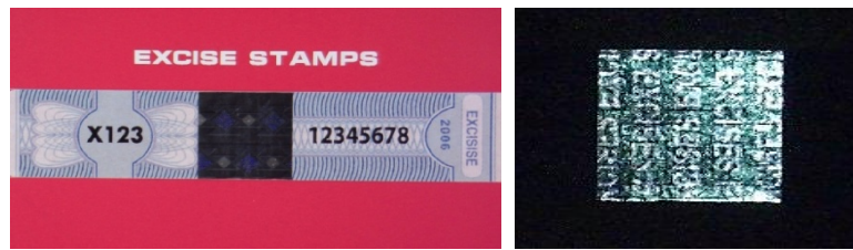
Рис. 9. Визуализация скрытых изображений с использованием поляризационного фильтра
