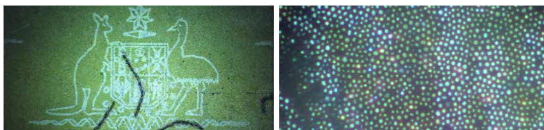
Рис. 7. Исследования ИК анти-Стоксовой люминесценции отдельных средств защиты
